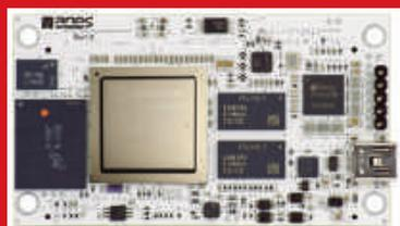
ARIES EMBEDDED PRÄSENTIERT SEIN SYSTEM ON MODULE 100PFZ. ES BASIERT AUF DER POLARFIRE-SOC-FPGA-FAMILIE VON MICROCHIP, DIE EIN **LEISTUNGSSTARKES** 64-BIT RISC-V MULTICORE-PROZESSOR-SUBSYSTEM MIT **STROMSPARENDER** FPGA-TECHNOLOGIE KOMBINIERT. DAS M100PFZ EIGNET SICH
