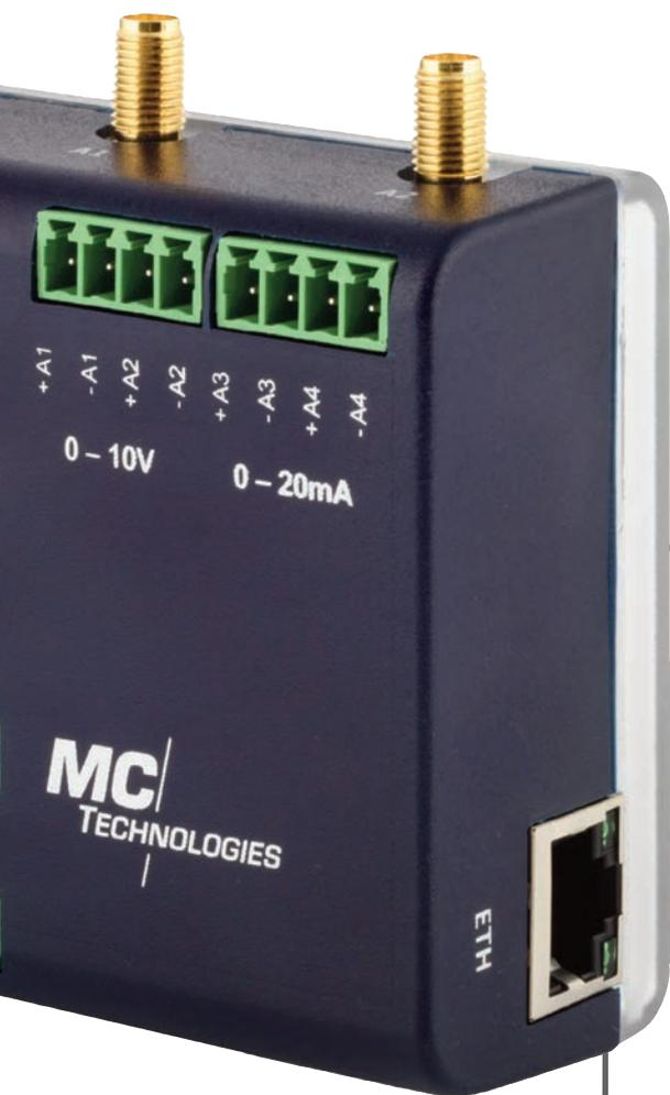
realisiert werden. Von Node-RED unterstützte IoT-Protokolle, wie MQTT, Azure, Modbus und die Verfügbarkeit eigener Knoten aus dem Haus MC Technologies, vereinfachen die Übermittlung von Messwerten, Schalt- und Zählerzuständen an Unternehmensserver, Visualisierungssoftware oder Cloud Services.
