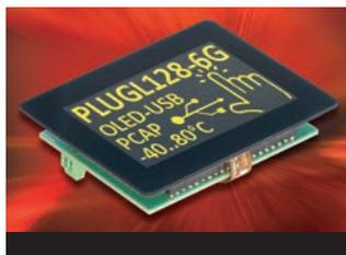
ES IST DURCH EINE **ROBUSTE, BERÜHRUNGSENSITIVE GLASSCHEIBE** GESCHÜTZT. DANK DIVERSE **DIGITALER EIN- UND AUSGÄNGE** KANN DAS DISPLAY KLEINE **STEUERUNGS-AUFGABEN SELBSTSTÄNDIG ÜBERNEHMEN**. DIE KOMMUNIKATION MIT MIKROKONTROLLERANWENDUNGEN KANN ÜBER **SPI-, I2C- ODER RS232-SCHNITTSTELLEN** ERFOLGEN.
