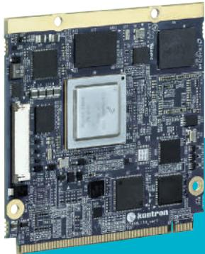
Das Kontron SMARC-sAMX8X Modul zeichnet sich durch seine geringe Energieaufnahme aus und bildet dank des leistungsstarken NXP i.MX8X Prozessor in Dual-Core- bzw. Quad-Core-Konfiguration eine ideale Basis für vernetzte Endgeräte in industriellen Anwendungen.
