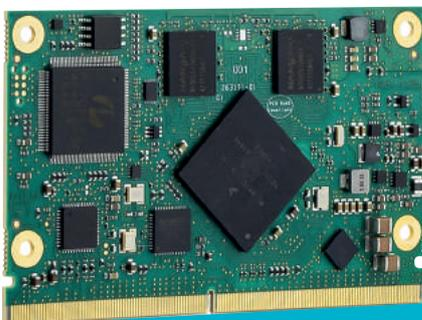
Das energieeffiziente SMARC-sAMX7 zeichnet sich dank seiner sparsamen Dual-Core- bzw. Single-Core-Konfigurationen durch eine besonders niedrige Energieaufnahme aus und ermöglicht so eine effiziente Entwicklung von intelligenten Geräten.
