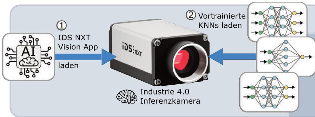
Die NXT-Industriekameras werden durch die KI-Vision-App zu universellen Inferenzkameras inklusive KNN-Beschleuniger. Mehrere vortrainierte Netze gängiger Architekturen können geladen und in wenigen Millisekunden zur Laufzeit umgeschaltet werden.
