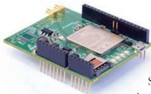
Mit der Integration eines NB-IoT-Shields hat Arrow seine flexible
